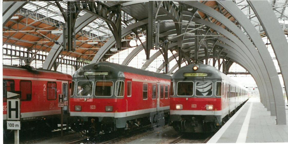
Die in den 1990er Jahren modernisierten Steuerwag. mit 'Karlsruher Kopf' erhielten in der Mehrzahl schon die neue Rot-Farbgebung der DB-Regio-Sparte. In dieser Form u. mit neu gestalteten Fahrgastbereichen kamen diese Steuerwag. noch bis Ende 2009
